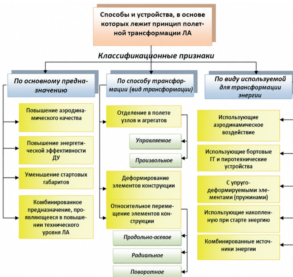
Рис. 2. Классификация способов и устройств, реализующих принцип полетной трансформации Fig. 2. Classification of flight transformation techniques and mechanisms
