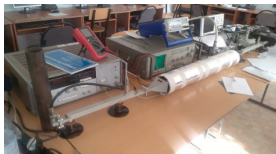
Рис. 5. Лабораторный стенд для изучения телеметрического канала связи
