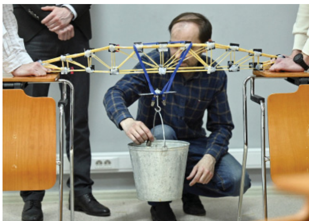
Рис. 13. Испытание фермы на грузоподъемность Fig. 13. Load capacity test of the truss
