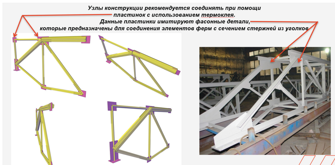
Рис. 12. Узлы фермы (мелкомасштабной и реальной)
